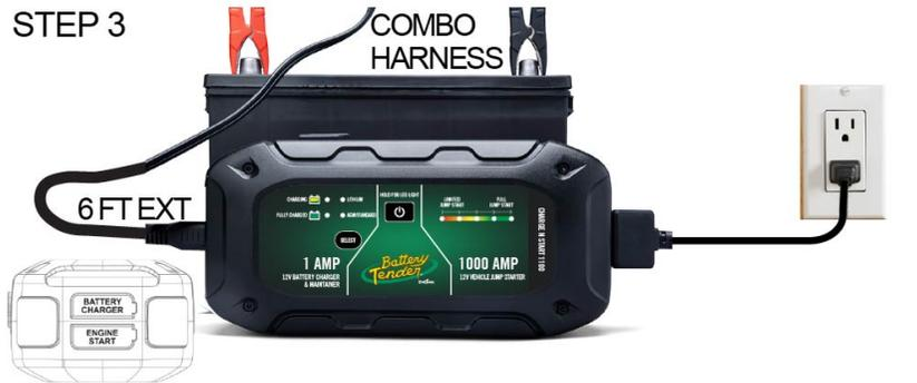
FIRSTLY CONNECT THE 6 FOOT EXTENSION CABLE TO THE COMBO CLIP HARNESS. THEN CONNECT THE QDC TO THE BATTERY CHARGER PORT. CONNECT THE COMBO CLIPS TO THE BATTERY POSTS (+ FIRST)
