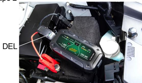
Connecter les pinces crocodile intelligentes à la batterie du véhicule (le voyant à DEL doit être vert, sans clignoter), puis démarrer le véhicule
